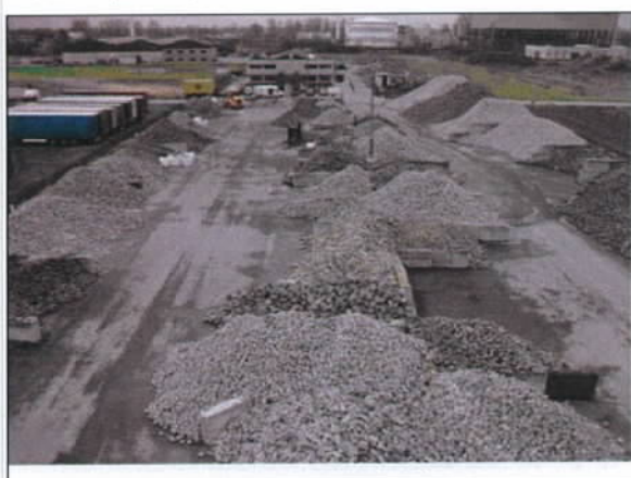
Grote voorraad keda porfier, hergebruikmaterialen en portugese mozaïekkasseien op depot SDS
